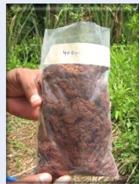
4) A los 0.20 m, abrir para sacar la segunda muestra, un aproximado de 1 libra de tierra, siempre utilizando un palin, depositarla en una bolsa plástica, identificarla y trasladarla al lugar donde va a ser analizada.
